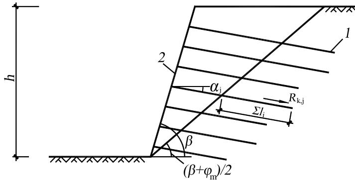
图 5.2.5 土钉抗拔承载力计算
