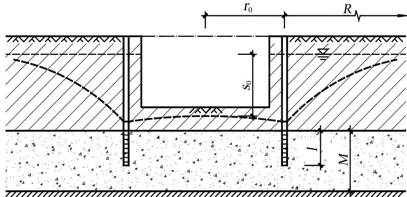
图 E.0.4 按均质含水层承压水非完整井简化的基坑涌水量计算
