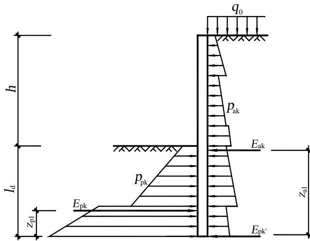
图 4.2.1 悬臂式结构嵌固稳定性验算
