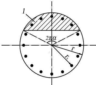
图 A.0.1 沿周边均匀配置纵向钢筋的圆形截面
